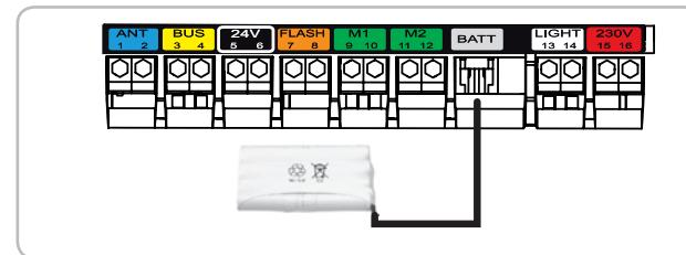
Установите аккумуляторную батарею на электронный блок с помощью двусторонней клейкой ленты.
