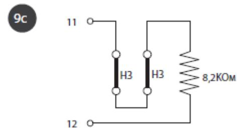
При подключении с функцией «Режим ожидания» вместо клеммы 11 поключить к клемме 8
