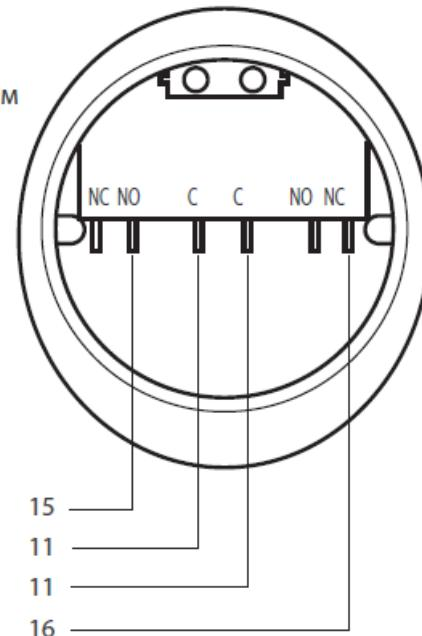
Для подключения входа ALT с функцией «Режим ожидания» вместо клеммы 11 подключить к клемме 8
